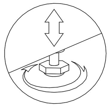
Для компенсации неровностей пола, произвести регулировку опор
