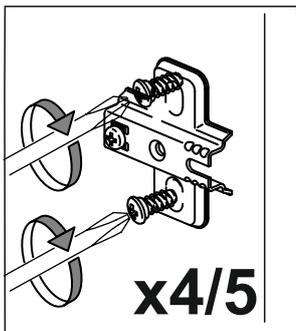
Выберите сторону открывания дверей и установите монтажные планки на боковые панели в указанные отверстия согласно вашей комплектации
