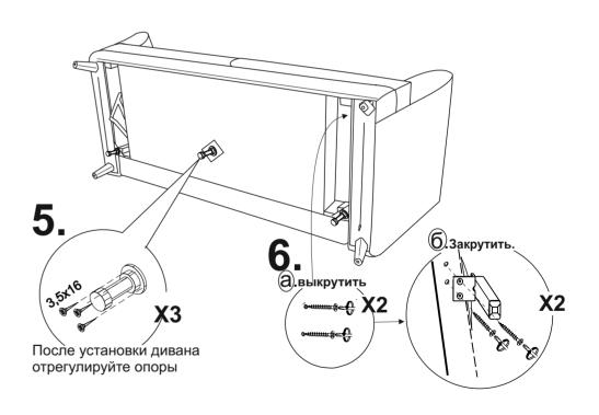
Внимание! Дополнительные опоры служат для распределения нагрузки.
