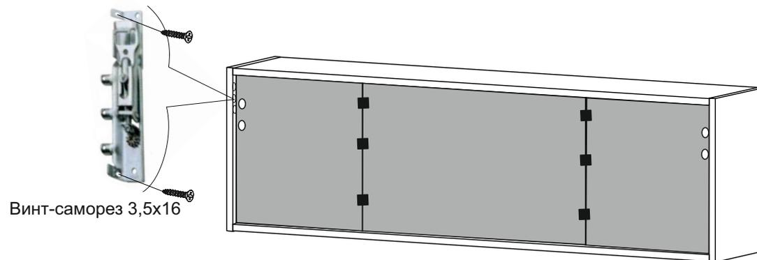
В стене просверлить два отверстия, вставить дюбели пластиковые (в комплект не входят) в отверстия. Через рейку навесную вкрутить саморезы.
