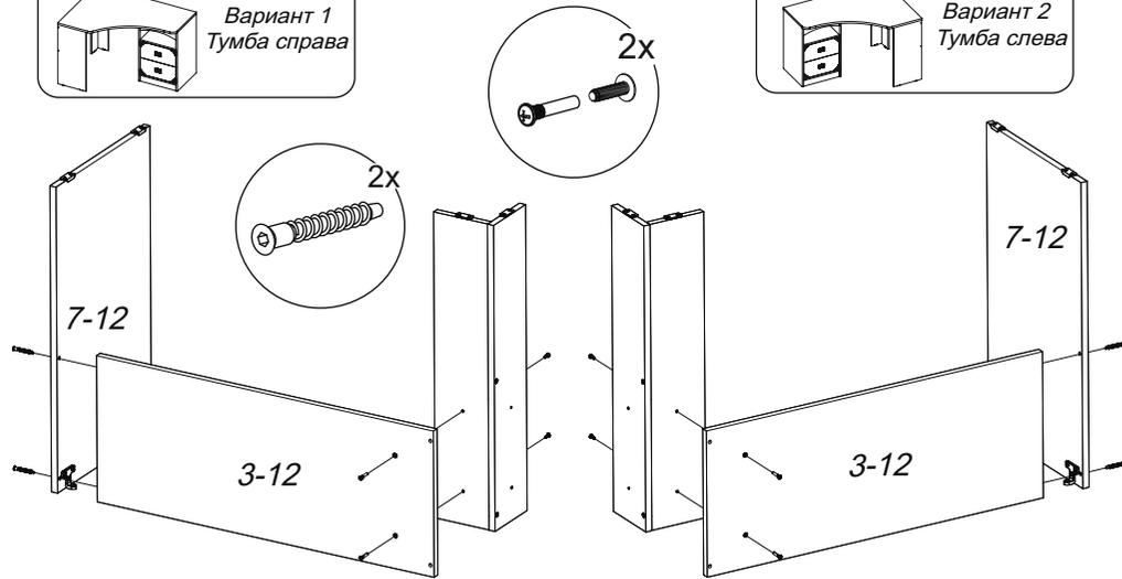
Для установки стяжных винтов, необходимо досверлить отверстия в детали 2-14 по уже имеющимся отверстиям детали 4-12. Сверлить необходимо на твердой поверхности, которую можно повредить, во избежание вырывания передней пласти детали.
