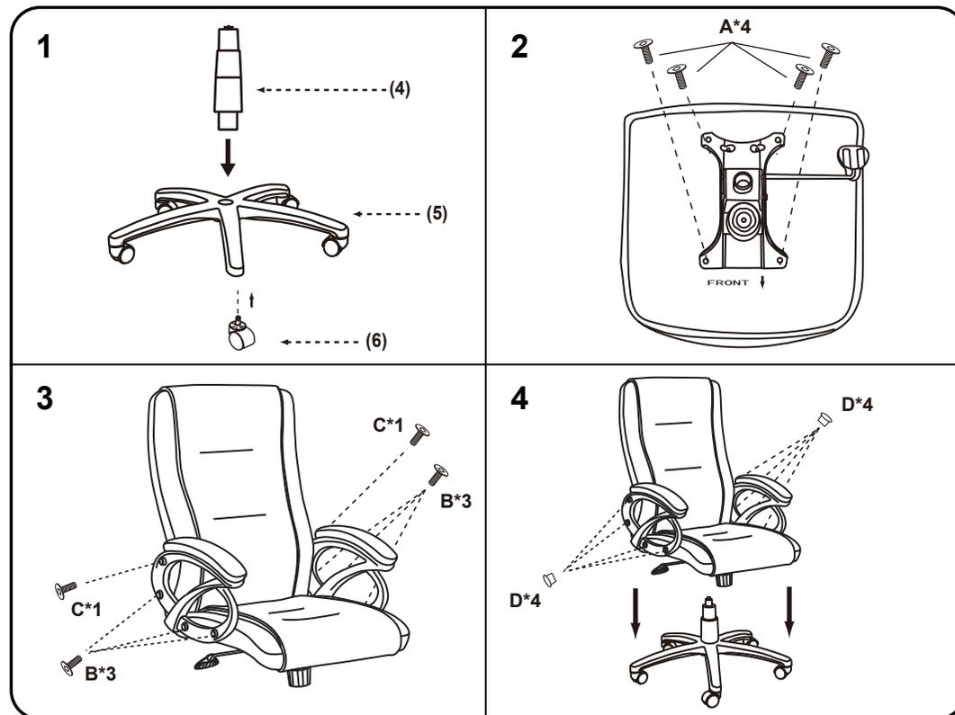
Вставьте и слегка затяните все винты. Когда сборка будет завершена, полностью затяните все винты перед использованием. Этот стул предназначен только для сидения. Любое другое использование аннулирует гарантию.
