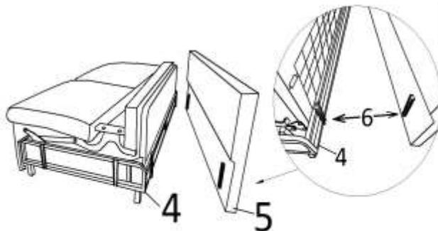
Соединить спинку(поз.5) опуская сверху вниз при помощи зацепов(поз.6) с механизмом(поз.4).
