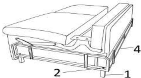
Установить опоры(поз.1, 4шт.) в посадочные отверстия механизма(поз.4), зафиксировать их с помощью гаек М8(поз.2) с шайбами.
