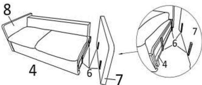
Соединить подлокотники(поз.7 и 8) опуская сверху вниз при помощи зацепов(поз.6) с механизмом(поз.4).
