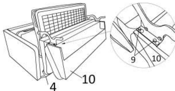
Соединить спинку(поз.10) с механизмом(поз.4) при помощи болтов(поз.9, 2шт. с каждой стороны)
