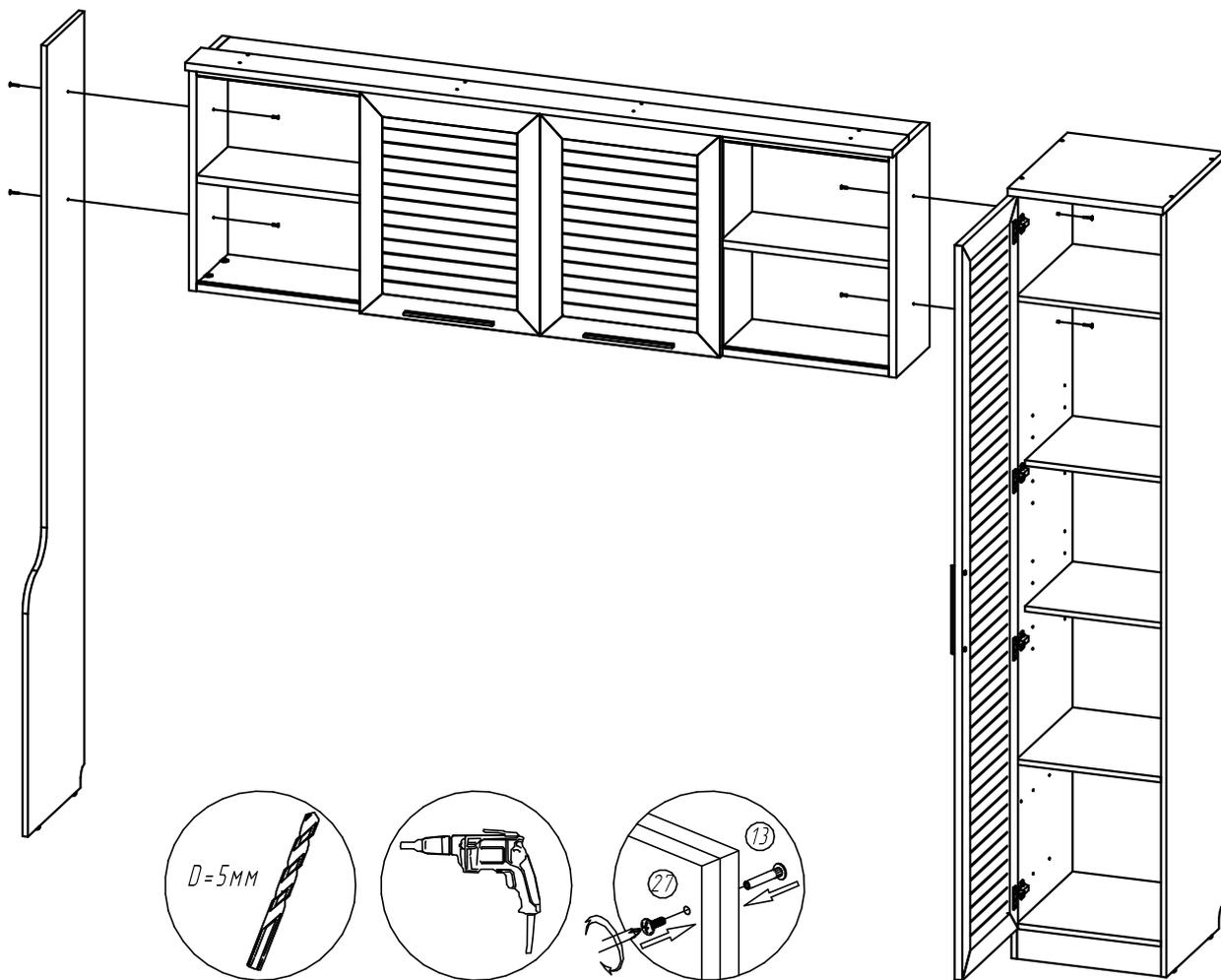
*При наличии в данной гарнитуре соседних изделий необходимо, используя фурнитуру (позиция №13, 14), стянуть их в единую конструкцию, предварительно просверлив в корпусах сквозные отверстия диаметром 5мм.*
