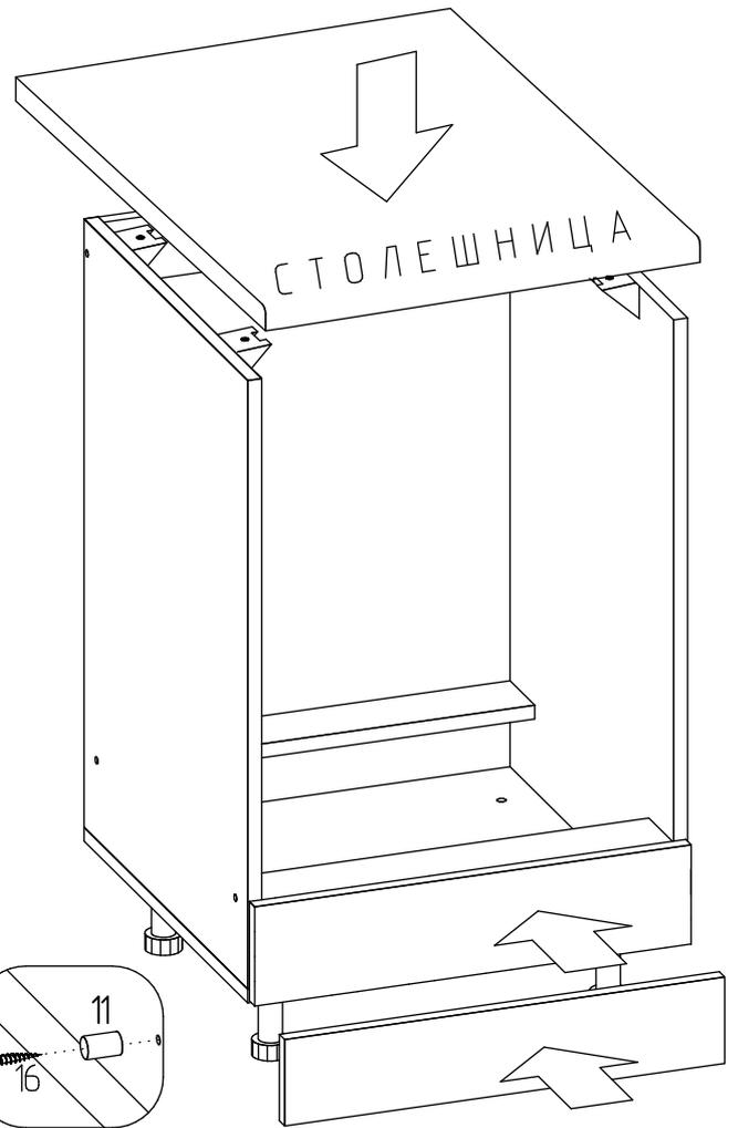
4. После сборки каркаса вставляется фасад (6) защелкой пластмассовой (12) в ответную планку защелки (11), затем прикручивается столешница шурупами (10) через уголки (15). Пристегивается цоколь (5).
