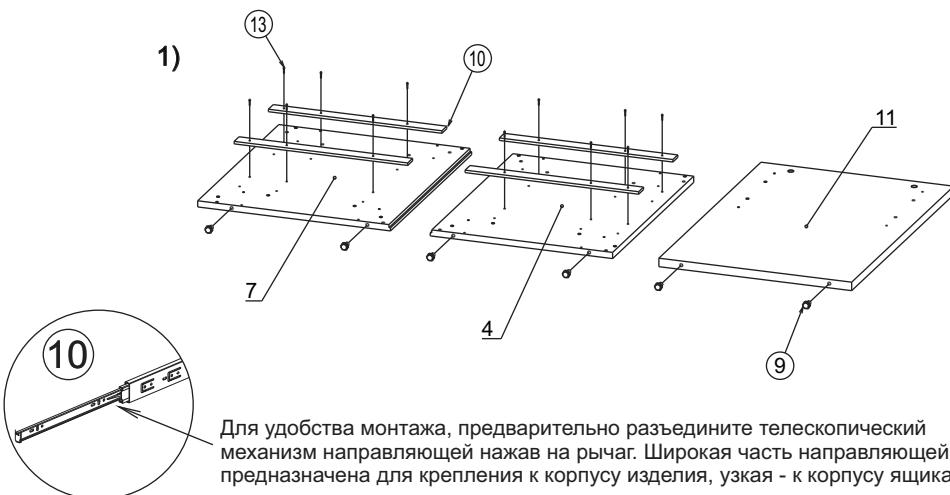
Для удобства монтажа, предварительно разъедините телескопический механизм направляющей нажав на рычаг. Широкая часть направляющей предназначена для крепления к корпусу изделия, узкая - к корпусу ящика.
