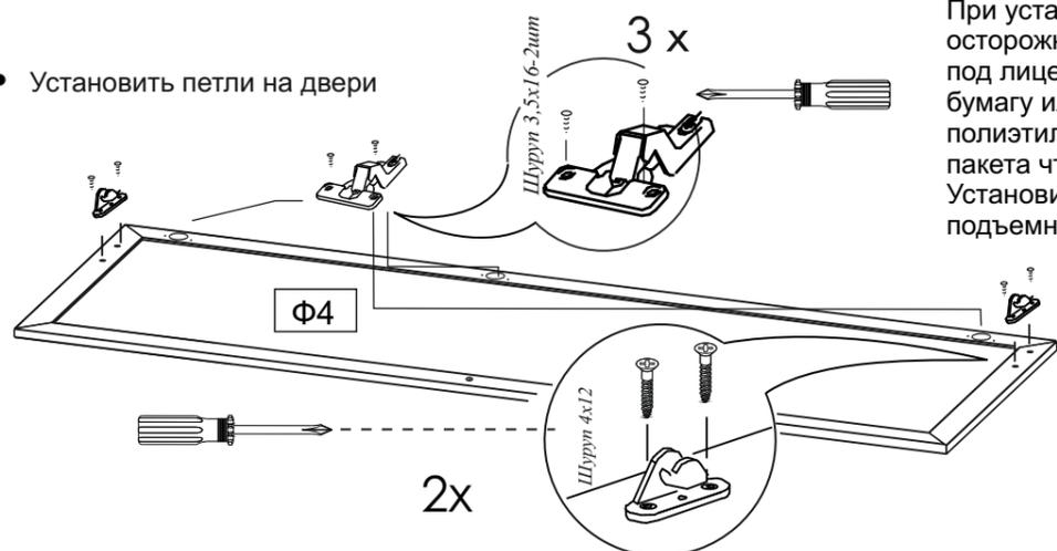
При установке петель соблюдать осторожность, подложить под лицевую сторону фасадов чистую бумагу или вспененный полиэтилен из упаковки пакета чтобы не повредить деталь. Установить элементы крепления подъемника
