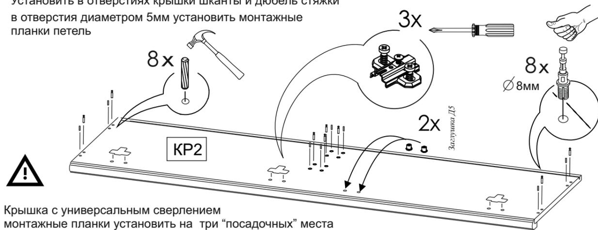
Крышка с универсальным сверлением монтажные планки установить на три "посадочных" места неиспользуемые отверстия закрыть заглушками. Монтажные планки установить в соответствии с расстановкой петель на двери (чтобы они совпали при установке фасада)
