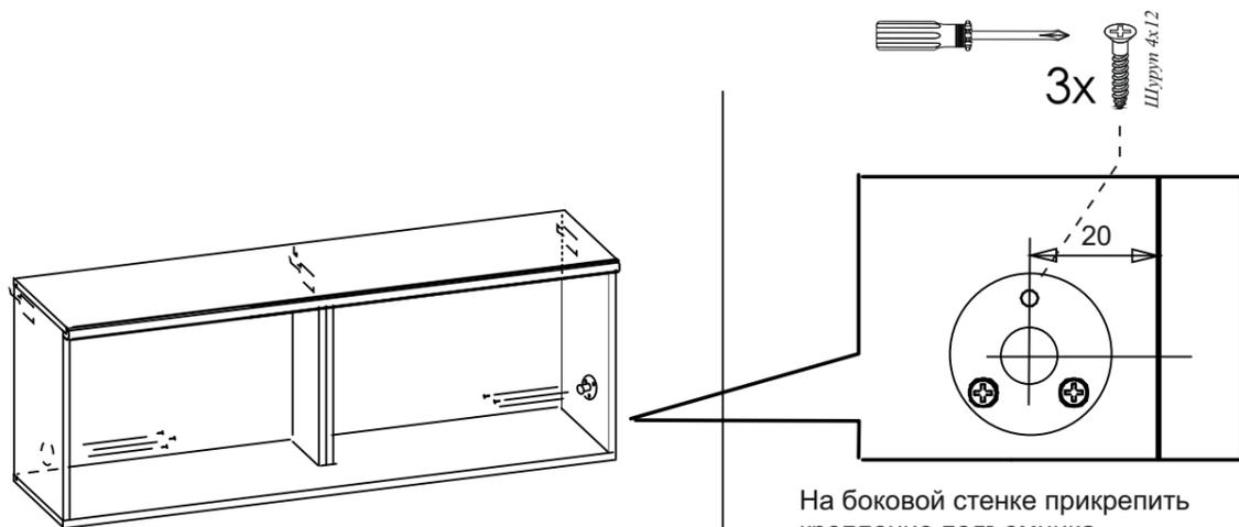
На боковой стенке прикрепить крепление подъемника. Одно отверстие под шуруп уже намечено, относительно этого отверстия расположить крепление чтобы его центр был на расстоянии 20 мм от края боковой стенки и вкрутить остальные шурупы по-месту.
