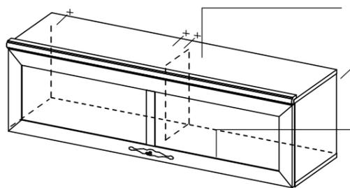
максимальная распределенная нагрузка на верхнюю крышку - не более 4-5кг , основной вес необходимо располагать ближе к боковым ст-кам, чтобы избежать прогиба верхней крышки;
