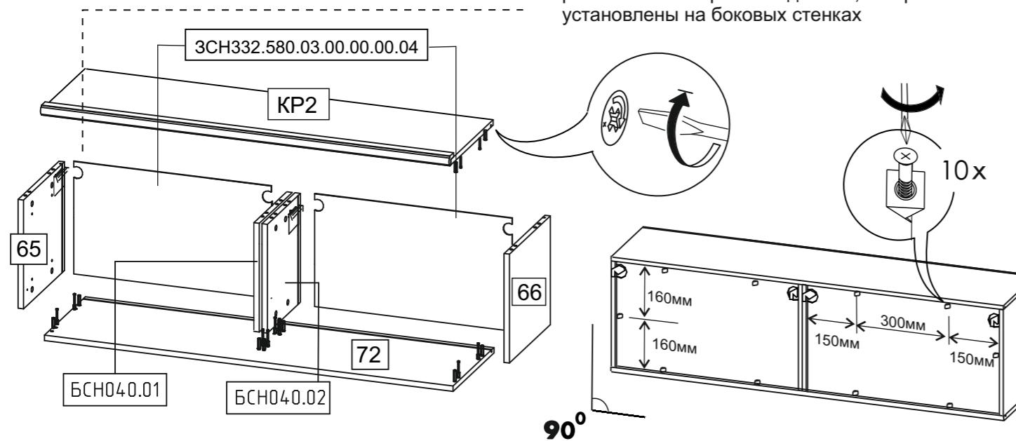
Зафиксировать детали задней стабилизаторами ДВП в паз.
