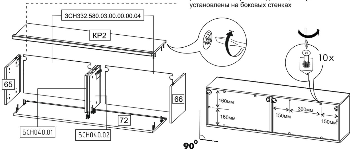
Зафиксировать детали задней стабилизаторами ДВП в паз.
