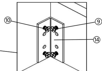
3. Соединить переднюю царгу, с подлокотниками и средней царгой кровати, с помощью 4 крепежных уголков, закрутив 14 винтов М6х35. и 2 М6х20 в среднюю царгу. Установите две крепежные косынки соединяющие подлокотник со спинкой и передней царгой, закрутив 8 винтов М6х35. Затяните все незатянутые ранее винты, до упора.
