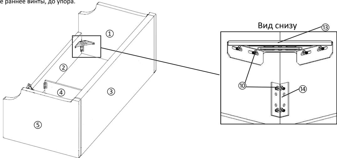
4. Установите ортопедическое основание к механизмам подъема, закрутив 4 гайки М8 на четырех винтах М8Х40, до конца не затягивая винты. Рекомендуем выровнять ортопедическое основание относительно каркаса кровати. Немного сдвинув его к боковой царге, чтобы не задевать подлокотник при подъеме. Затянуть винты до конца!
