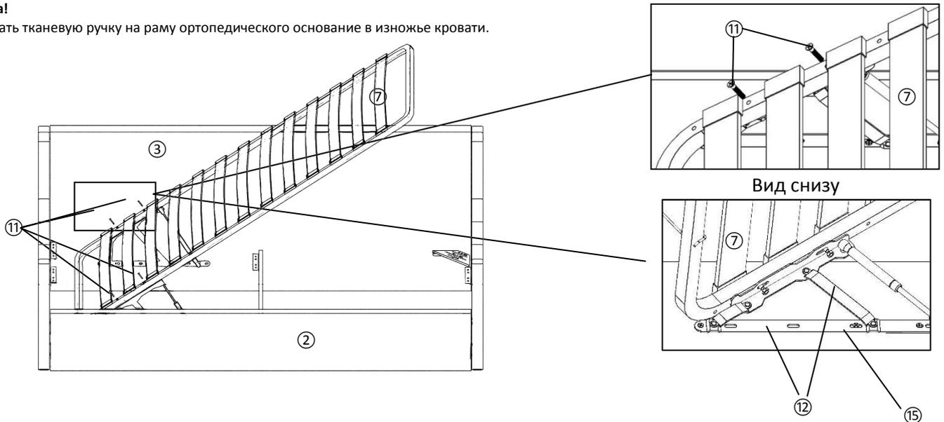
5. Установите газлифты штоком вниз, защелкнув их на шаровую опору механизма подъема. Для демонтажа газлифтов в местах крепления газлифтов освобождаем металлические зажимы при помощи отвертки и снимаем газлифты с шаровых опор.
