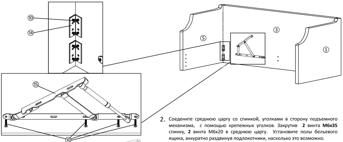
2. Соедините среднюю царгу со спинкой, уголками в сторону подъемного механизма, с помощью крепежных уголков. Закрутив 2 винта М6х35 спинку, 2 винта М6х20 в среднюю царгу. Установите полы бельевого ящика, аккуратно раздвинув подлокотники, насколько это возможно.
