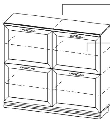
максимальная распределенная нагрузка на верхнюю крышку - не более 10кг, основной вес необходимо располагать над перегородкой, чтобы избежать прогиба верхней крышки;
