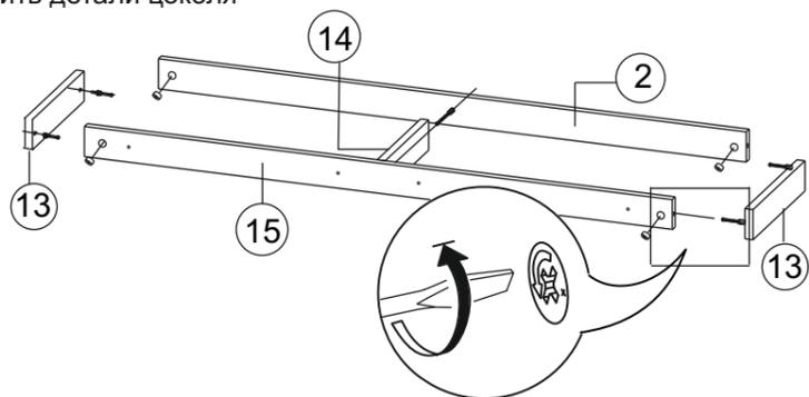
обратить внимание на отверстия в торцах деталей цоколя располагать детали так, чтобы отверстия на всех деталях были повернуты в одну сторону. Они потребуются на последующем этапе сборки, для соединения цоколя с нижней крышкой
