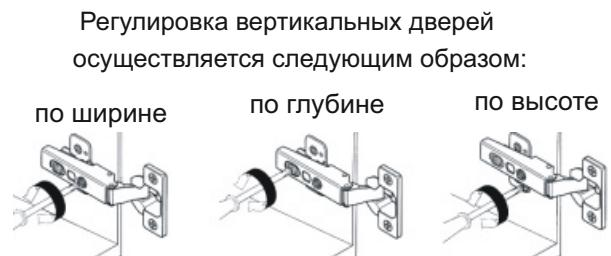
Регулировка вертикальных дверей
