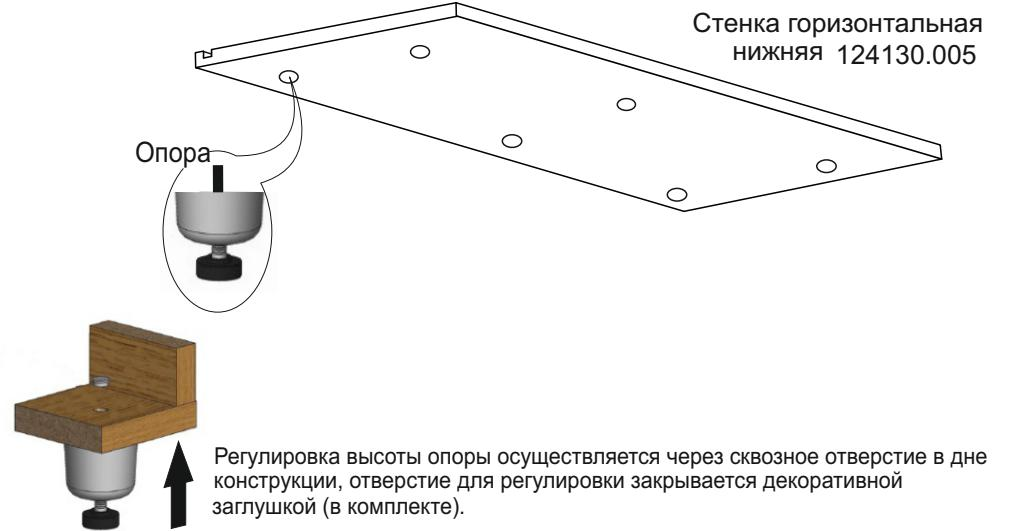
Регулировка высоты опоры осуществляется через сквозное отверстие в дне конструкции, отверстие для регулировки закрывается декоративной заглушкой (в комплекте).
