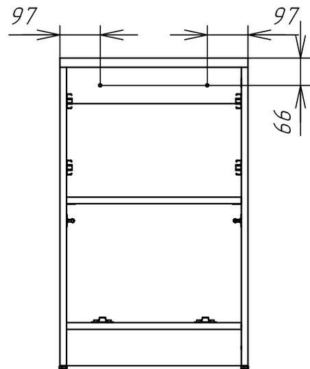
При необходимости - изделие можно закрепить к стене через отверстия в детали №8 с помощью фурнитуры №79 и 80 предварительно вытащив верхний ящик.
