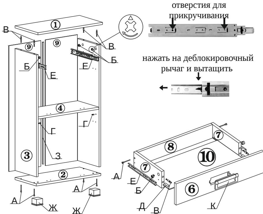
1. В отверстия на боковинах (дет.№3) закрутите ввинчиваемые дюбели (поз.Г) и вставьте эксцентрики (поз.Б). Обратите внимание: стрелка на эксцентрике должна быть направлена к верхнему торцу детали. Шурупами 3,5x16 закрепите шариковые направляющие .
