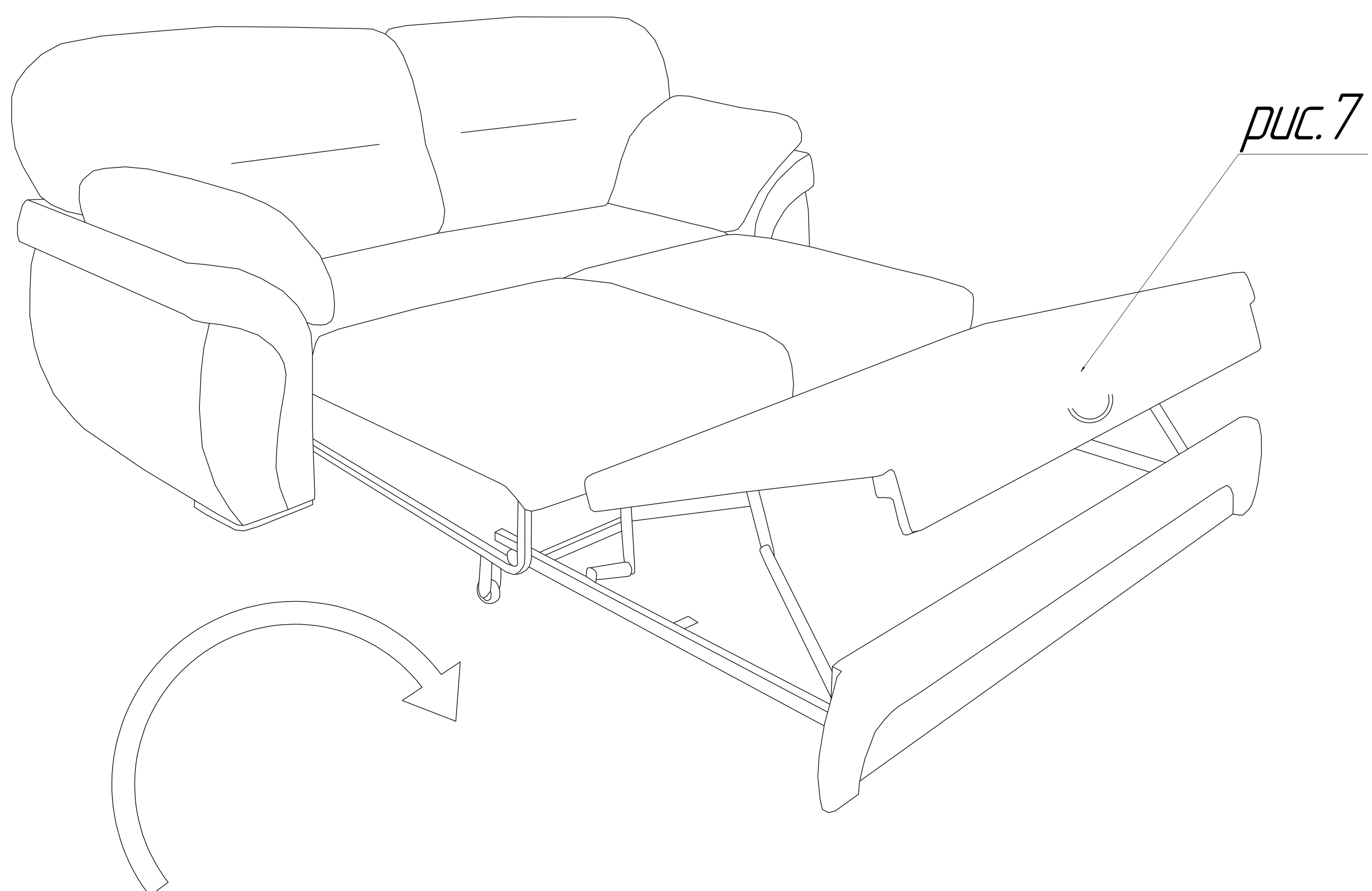
*3. Схема раскладывания механизма трансформации.*
