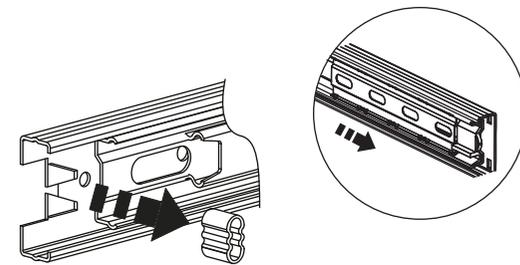
Для улучшения работы направляющей при установке доводчика извлечь резиновый ограничитель хода с направляющей.
