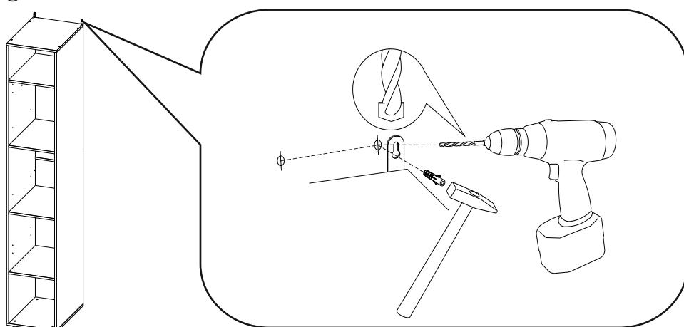
Для избежания повреждения газовых, вентиляционных водопроводных отверстий и электрических коммуникаций, обратите внимание на их расположение!
