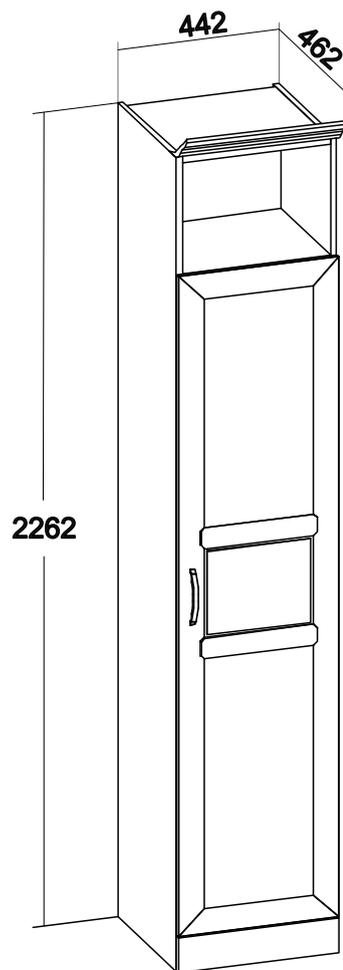
Карниз приобретается отдельным модулем и крепится Винтом-саморезом 3x20
