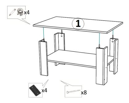
Штоки эксцентрика вкручиваются в крышку (поз.1). Крышка (поз.1) устанавливается на каркас, выравнивается и затягивается эксцентриком. К каждой ножке прибивается подпятник гвоздем 1,6х25.
