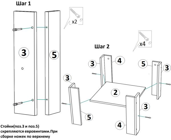
скрепляются евровинтами.При сборке ножек по верхнему краю стойки(поз.3 и поз.5) выравниваются.Обращаем внимание,что ножки стола собираются из стоек(поз.3 и поз.4) и стоек(поз.3 и поз.5) (отверстия для эксцентрика внутри угла).
