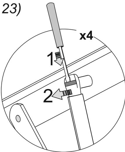
Для снятия газового амортизатора:
