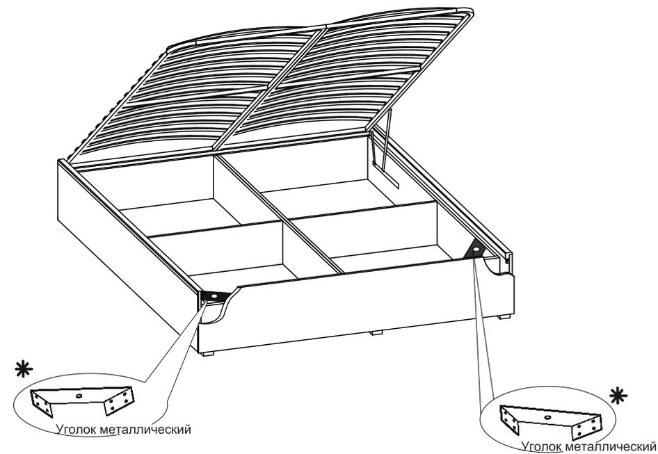
Уголок металлический прикрепить винтом- саморезом 3,5x32
