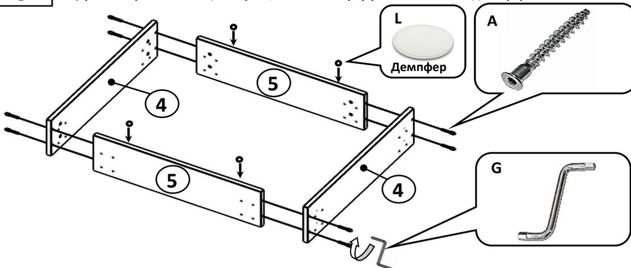
**6** Собранные ноги приворачиваются шурупами 4x30 к царгам так как показано на рисунке, через отверстия имеющиеся в царгах таким образом, чтобы верхняя часть ног и царг была на одном уровне, и между ними не было зазоров. После чего шляпки шурупов закрываются самоклеющимися заглушками.
