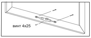
• Отрегулировать положение дверей с помощью петель.
