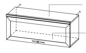
максимальная распределенная нагрузка на верхнюю крышку - не более 4-5кг, основной вес необходимо располагать ближе к боковым ст-кам, чтобы избежать прогиба верхней крышки;
