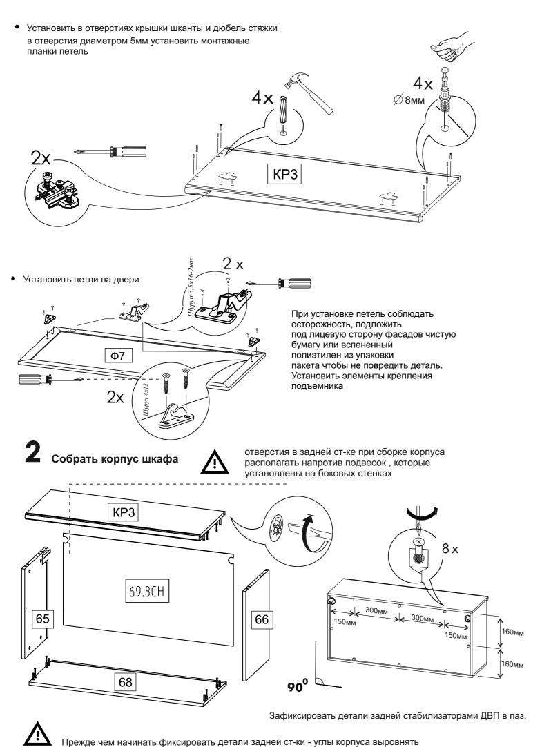
• Определить положение корпуса на стене, обвести мягким карандашём контур корпуса и установить на стену шины подвесок.
